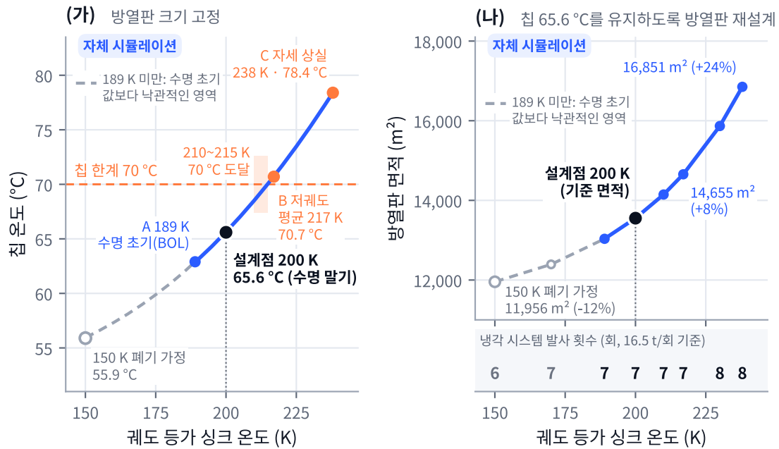
그림 10. 방열 면적을 고정하면 설계점 부근에서 궤도 등가 싱크 온도가 10 K 높아질 때마다 칩 온도는 약 3 K 상승합니다. 칩 온도는 설계점 200 K(수명 말기)에서 65.6 °C이며, 210~215 K 사이에서 한계 70 °C에 도달합니다(가). 칩 온도를 65.6 °C로 유지하도록 방열 면적을 재산정하면, 238 K(자세 상실)에서 면적은 24% 증가하고 냉각 시스템 발사 횟수는 7회에서 8회가 됩니다(나, 낙관적 면밀도 가정 기준).
